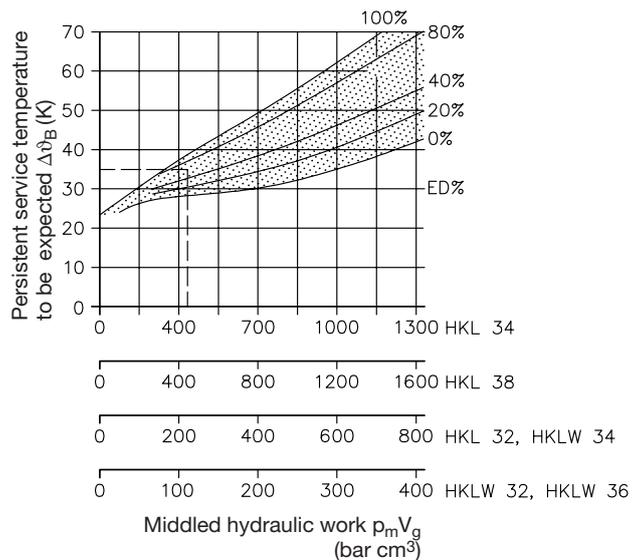
$$\vartheta_{oil\ B} = \Delta\vartheta_B + \vartheta_U$$
